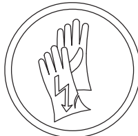
USO DE GUANTES DIELECTRICOS
